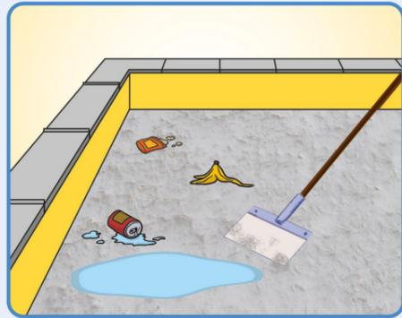
Kies abschern und entsorgen, Dachfläche reinigen.
