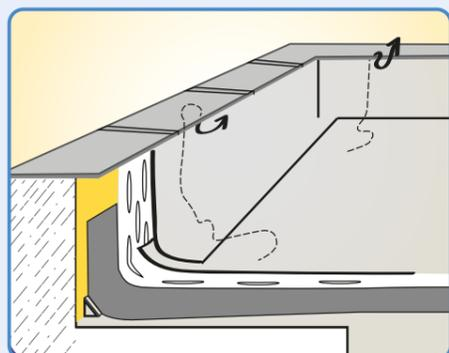
Falls erforderlich wird eine Bahn als Dampfdruckausgleichsschicht verlegt, um spätere Blasenbildung zu vermeiden.
