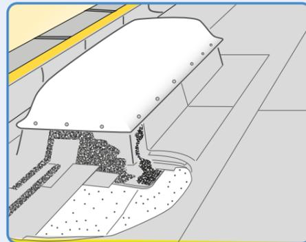
Lichtkuppeln, Kamin usw 2-lagig abdichten und fingerförmig in die Flächenabdichtung einbinden.
