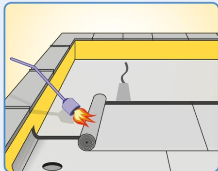
Dehnungsrisse und -fugen elastisch mit Schleppstreifen überbrücken. Erste Lage Flächenabdichtung verlegen.
