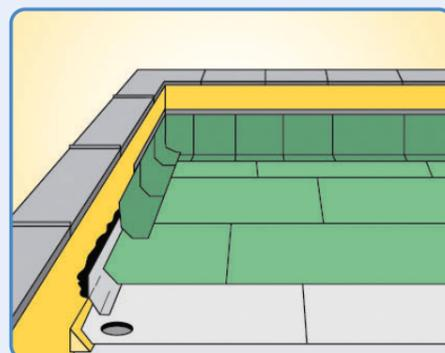
Zweite Lage Dachhaut verlegen. Hochzüge herstellen, evt. mit mechanischer Befestigung.
