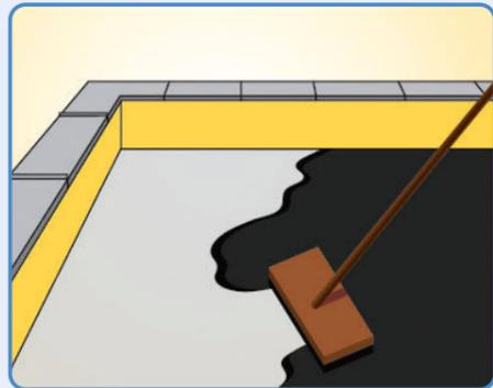
Voranstrich satt und vollflächig auftragen, als Staubbinder und Haftbrücke.
